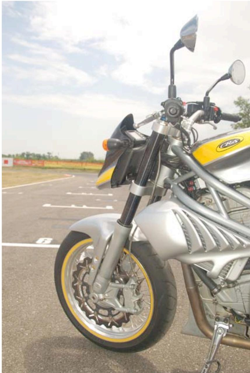
Davanti al motore il puntale altri non è che il serbatoio dell'olio a fianco del quale passano i tubi di scarico (uno per ogni valvola di scarico) che vanno successivamente a raccordarsi con la marmitta ovale posta sotto il basamento del motore.
