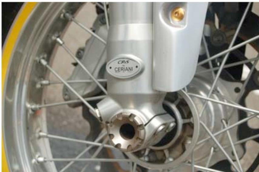
I foderi della forcella sono in lega leggera ricavati dal pieno integranti un piedino per pinza freno ad attacco radiale. L'idraulica è composta da una cartuccia estraibile e le regolazioni si possono effettuare su precario molla, su estensione e compressione dell'idraulica.
