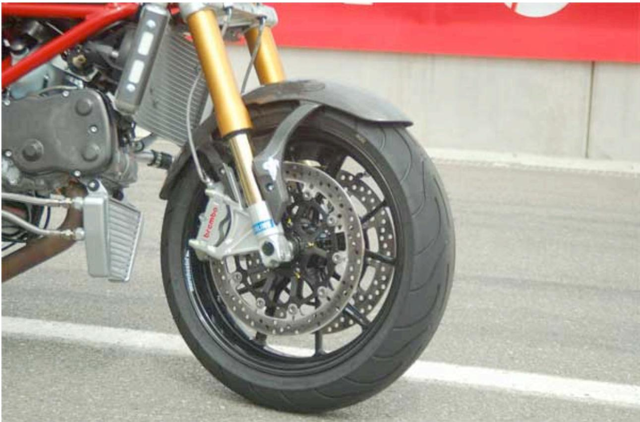
All'anteriore l'S4Rs è dotato di una pompa radiale con flottante da 19 mm di diametro con serbatoio olio separato abbinato ad una coppia di pinze freno ad attacco radiale, a quattro pistoncini da 34 mm di diametro e a quattro pastiglie.
