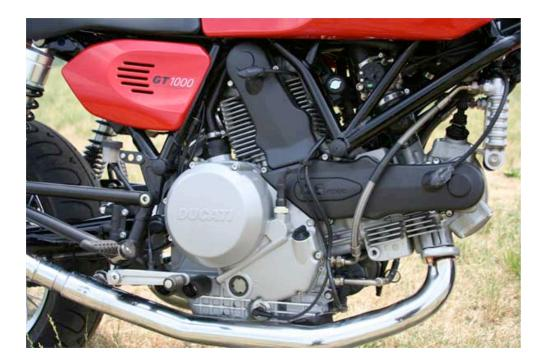
Gli scarichi che adottano due catalizzatori trivalenti portano alla moto il raggiungimento dell'omologazione euro 3, senza togliere brio al motore e soprattutto lasciano cantare il bicilindrico.
